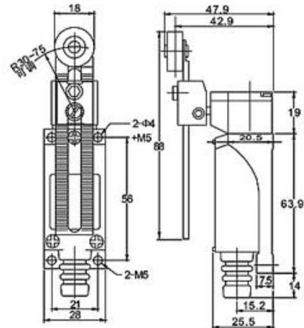
Рис. 4. ВП 25-2143/45 (рычаг с роликом, регулируемый по длине)
