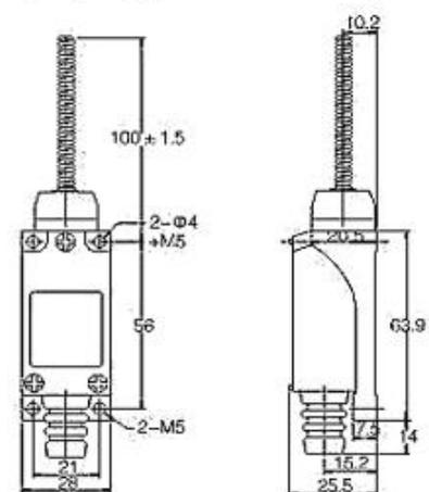
Рис. 6. ВП 25-2108 (рычаг пружинный)
