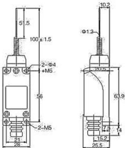
Рис. 5. ВП 25-2106 (рычаг пружинный "кошачий ус")
