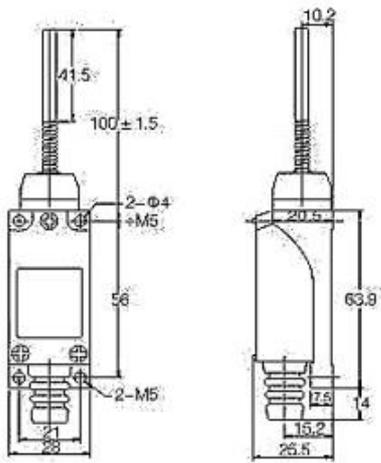
Рис.7. ВП 25-2107 (рычаг пружинный с пластиковым наконечником)
