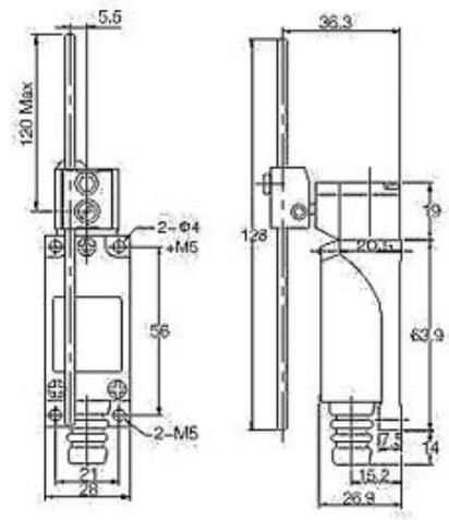
Рис.8. ВП 25-2153 (круглый стальной рычаг, регулируемый по длине)
