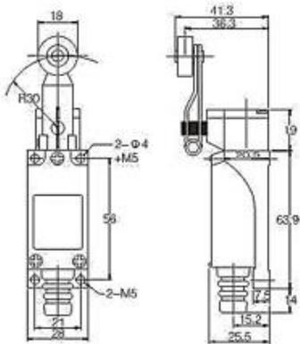
Рис. 3. ВП 25-2116/18 (рычаг с роликом)
