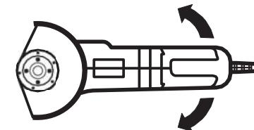
Изделие с раскручивающимся или останавливающимся диском (дисками) обладает повышенным боковым крутящим моментом. Не выпускайте его из рук при запуске и выключении до полной остановки диска
