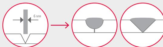
Узкая конструкция идеально подходит для U-образных и V-образных сварных швов
