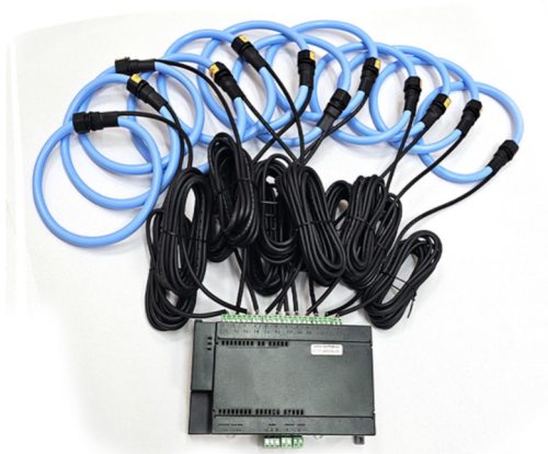
Рисунок 10 – Внешний вид датчика КСР-7 с 12 каналами подключения
