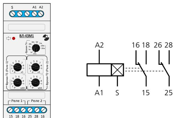
**ВНИМАНИЕ!** Для исключения сбоев в работе реле при коммутации индуктивной нагрузки (электромагнит, электромагнитный клапан и др.), подключите непосредственно к клеммам нагрузки помехоподавляющую цепь в виде последовательно соединенных резистора 100 — 200 Ом 2Вт и неполярного конденсатора 0.1 — 0.22 мкф 400 — 600В.
