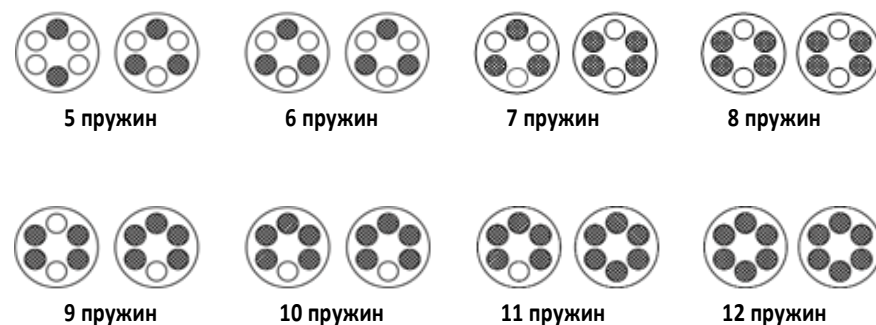
Схема установки возвратных пружин
