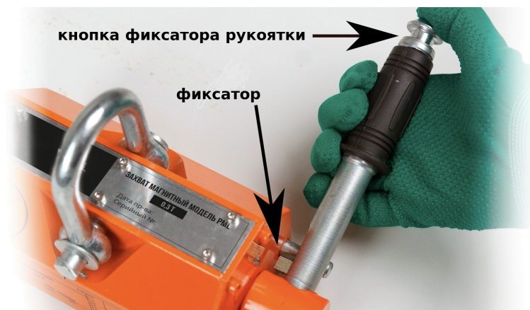
Рисунок 3. Порядок работы с магнитным захватом.
