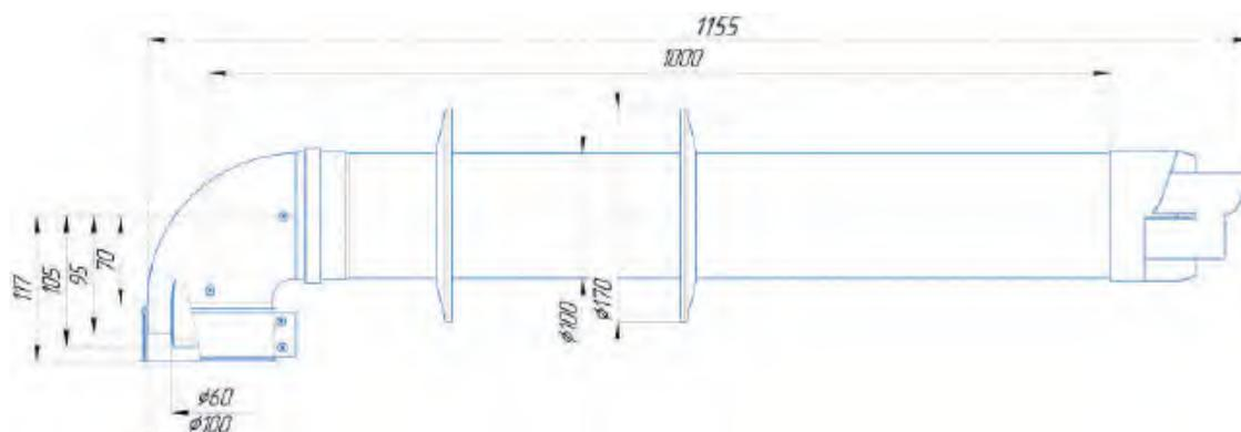
**УДЛИНИТЕЛЬ КОАКСИАЛЬНЫЙ D60/100 L2000 мм**
