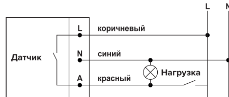
Рис. 6. Схема подключения датчика с добавлением настенного выключателя в цепь для ручного подключения нагрузки.
