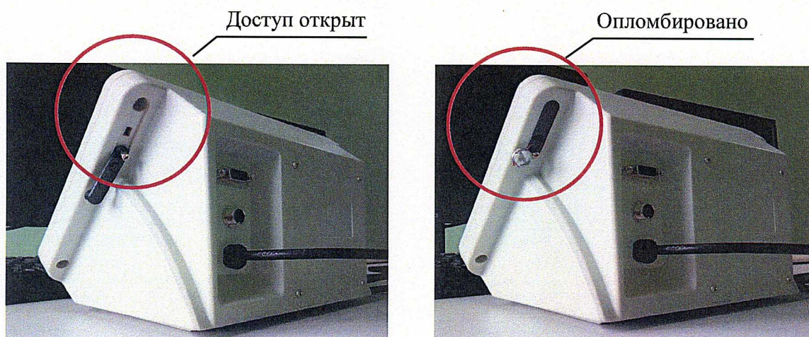
Рисунок 2 – Схема пломбировки от несанкционированного доступа
