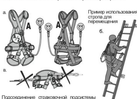
Рис. 8. Использование стропы с амортизатором рывка
