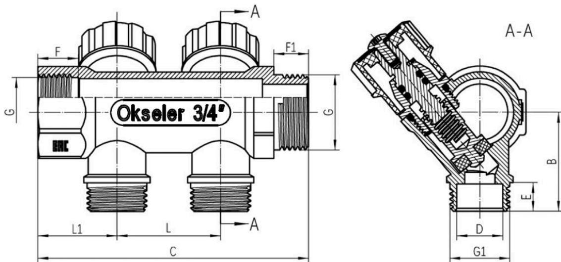
Рис.2 – Размеры коллектора с регулирующими вентилями
