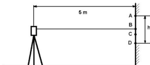
Установите лазерный уровень на штатив в 5 м от стены так, чтобы горизонтальный лазерный луч был направлен к стене. Включите питание и дождитесь завершения процесса самовыравнивания.
