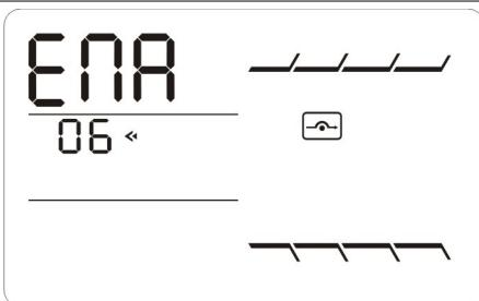
Разрешает или запрещает байпас при выключенном, но подключенном к входному напряжению ИБП
