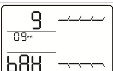
Позволяет установить емкость подключенной к ИБП аккумуляторной батареи в А/ч:
