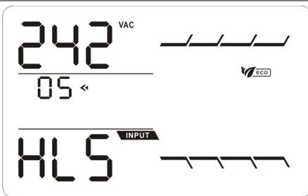
Позволяет задать диапазон входного напряжения, при котором будет работать эко-режим:
