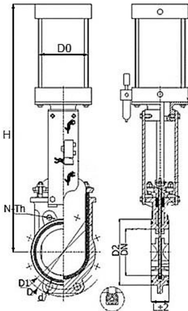
Рисунок 2 – Размеры задвижки с пневмоцилиндром
