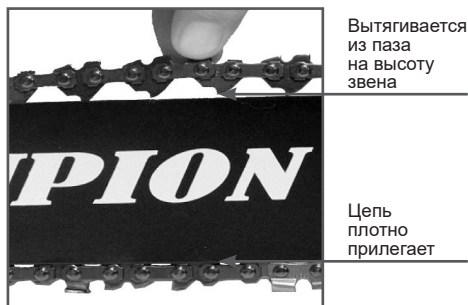
Рис. 5 Регулировка натяжения цепи
