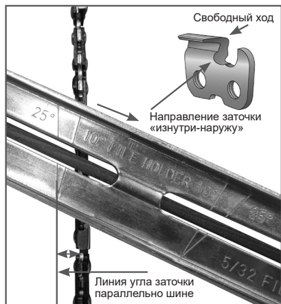
Рис. 29 Определение угла заточки
