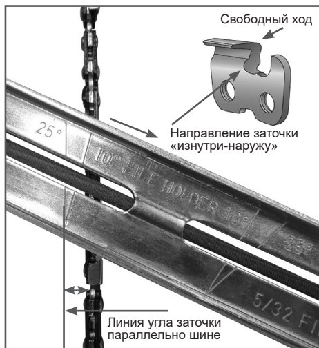
Рис. 17 Определение угла заточки
