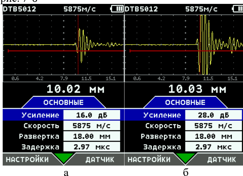
Рис.7-6. Иллюстрация эффекта от изменения коэффициента усиления а) усиление 16дБ, б) усиление 28 дБ.
