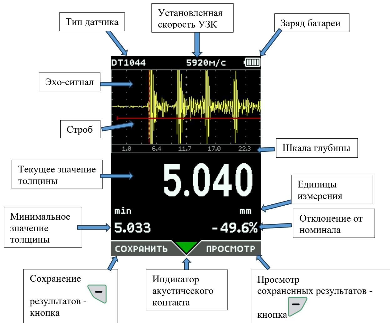
Рис.7-26. Экран прибора в режиме А-скан
