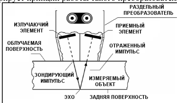
Рис. 5.6 Принцип работы р/с преобразователя
