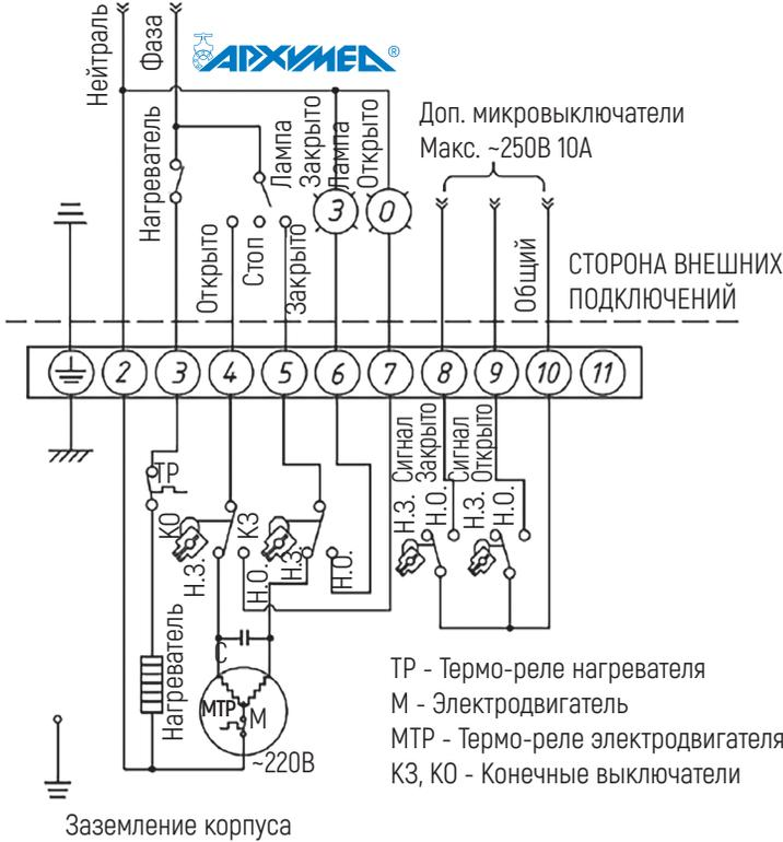
Схема подключения AR11E015-600 220В/50, 1 фаза (режим двухпозиционный)
