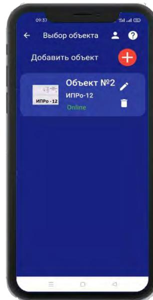
Если поиск не дал результата, убедитесь, что данные Wi-Fi введены правильно, и включен Wi-Fi -модуль вашего телефона. Убедитесь, что Wi-Fi роутер работает на частоте 2.4 ГГц. Перезагрузите прибор и выключите\включите Wi-Fi - модуль вашего телефона, повторите действия начиная с пункта 3 данного раздела.
