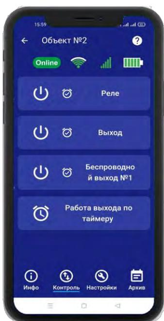
Пример включения выхода «Реле»:
