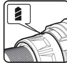
Во избежание травм, не заворачивайте шурупы в положении
