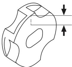
Рис. 22 Максимально допустимая глубина износа зубцов ведущей звездочки
