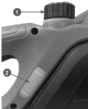
Рис. 6 Крышка масляного бака и указатель уровня масла
