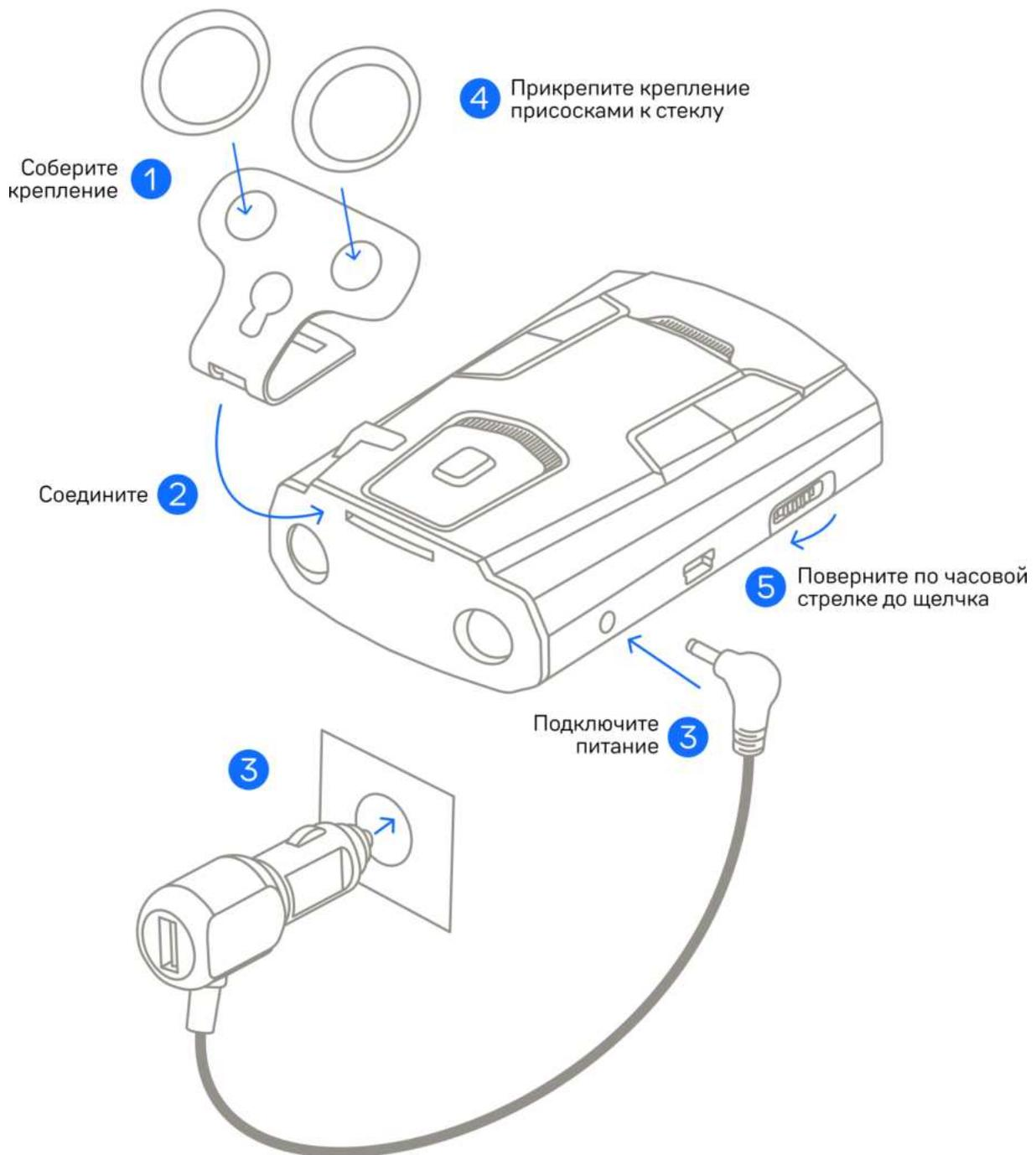
Для установки устройства на лобовое стекло автомобиля используйте крепление на присоске:
