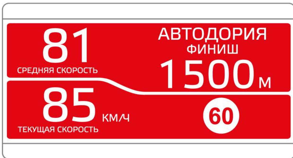
Если скорость автомобиля превышает разрешённую (перед такими камерами полиции, как Кордон, Одиссей, Робот, Кречет, Места, Поток). При этом учитывается допустимое превышение скорости, установленное в разделе **Основные настройки**.
