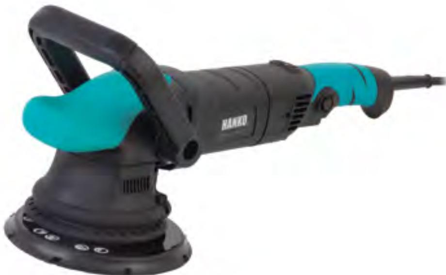
Легкая, малогабаритная, идеально сбалансированная машинка с орбитальным ходом 21 мм и подошвой 150 мм. Идеально подойдет для полировки любых поверхностей, даже большой площади. Прорезиненная передняя рукоятка и резиновые вставки в корпус инструмента обеспечивают комфортную работу оператора. Наличие 2-х ручек (скоба и боковая) дает возможность максимально настроить машинку для всех видов работ.
