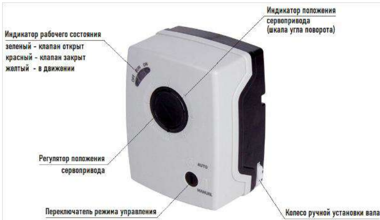
Рис.2 – Обозначение основных элементов управления сервопривода OKSELER Oks00715
