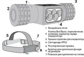
Рис. 2. НАДЕВАНИЕ РЕМШКА НА АДАПТЕР И РЕГУЛИРОВКА
