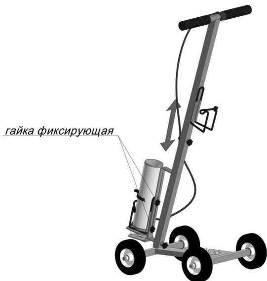
Для увеличения ширины полосы фиксации баллона переместите вверх, для уменьшения ширины - опустите вниз. Нажмите рычаг на руле, передвиньте тележку вперёд и убедитесь, что наносится полоса нужной ширины. После регулировки зафиксируйте гайки.
