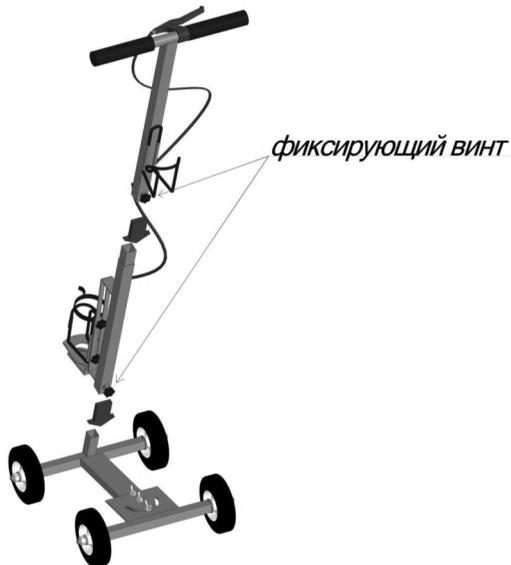
После сборки тележка для разметки готова к работе.
