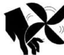
5. Регулярно удаляйте пыль с помощью чистого и сухого сжатого воздуха; если условия работы связаны с сильным задымлением и загрязнением воздуха, сварочный аппарат следует чистить ежедневно.
