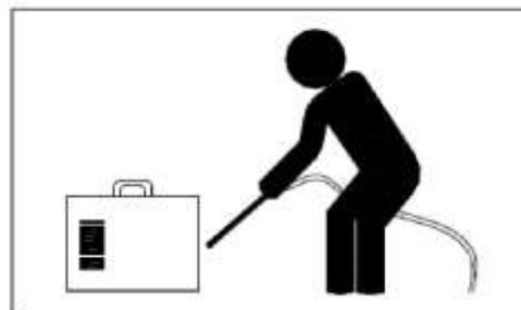
7. Чтобы избежать попадания воды и дождя, если таковые имеются, своевременно высушите его и проверьте изоляцию с помощью мегаомметра (включая изоляцию между соединением и изоляцию между корпусом и соединением). Сварку следует продолжать только при отсутствии каких-либо аномальных явлений.
