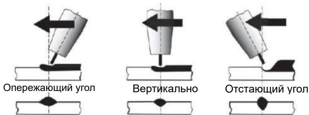
Сварочный пистолет следует держать под углом к сварному шву (см. Дополнительные параметры настройки ниже). Держите пистолет так, чтобы сварочный шов был постоянно виден. Всегда надевайте сварочную маску с соответствующими фильтрующими линзами и используйте соответствующее защитное снаряжение.
