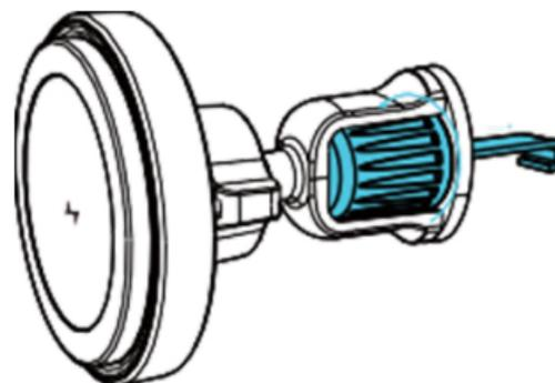
3. Затяните ручку до тех пор, пока крючок не будет плотно зацеплен за лопасть вентилятора. После того как ручка затянется, не продолжайте ее натягивать, чтобы не повредить выпускное отверстие для воздуха.
