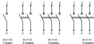
Рисунок 2 – Схемы электрические BA 47-65
