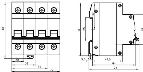
Рисунок 1 – Габаритные и установочные размеры BA 47-65
