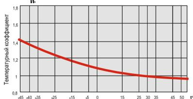
Рис. 4. Коэффициент пересчета номинального тока выключателей в зависимости от температуры окружающей среды
