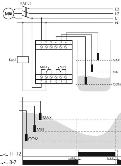
При подаче питания через 2 секунды реле входит в рабочий режим, контакты 8-7 остаются разомкнуты (11-12 замыкаются). Если уровень жидкости выше зонда MAX, контакты реле 8-7 замкнуты (11-12 разомкнуты), насос включается и происходит откачка жидкости из резервуара. При достижении жидкостью уровня MIN контакты 8-7 размыкаются (11-12 замыкаются), насос выключается. При повышении уровня жидкости до уровня зонда MAX контакты 8-7 замкнутся (11-12 разомкнутся), включится насос.
