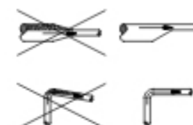
Fig.5 Правильное подключение трубопровода на стороне всасывания насоса.
