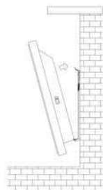
Σχήμα 9. Προσάρμογη της επάνω κρεμάστρας του βραχίονα στερέωσης στη
