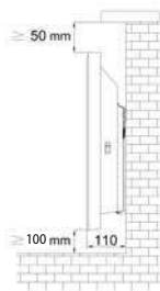
Fig. 11 Dimensiuni convector după montaj
