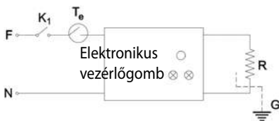
4. ábra Panel konvektor (digitális) elektromos áramkör
