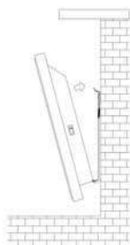
Slika 9. Postavljanje gornje kuke na konvektor
