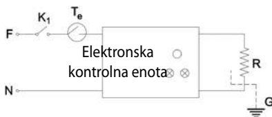
Slika 3. Električna shema digitalnega panelnega grelnika
