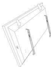
Figura 10. L'inserimento del gancio superiore, veduta da dietro
