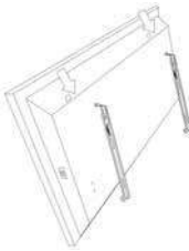
Şekil 10. Üst kancanın takılması arkadan görünüş
