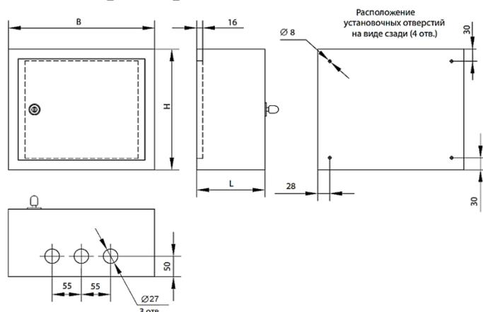
Рисунок 1. Габаритно-установочные размеры щитов с монтажной панелью ЩМП
