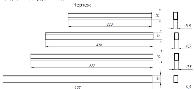
Рисунок 1г – Габаритные размеры блока питания.
