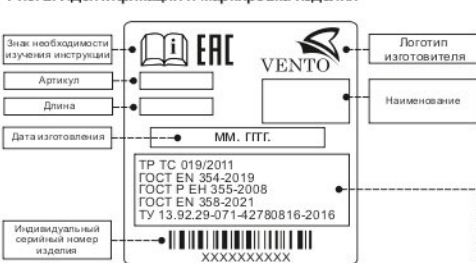
Рис. 2. Идентификация и маркировка изделия
