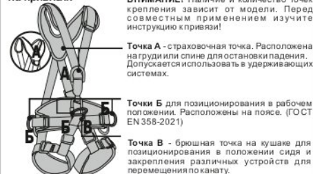
Рис. 3. Расположение и назначение крепежных точек на привязях
