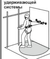
Рис. 15. Способ организации удерживающей системы
