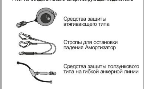
Рис. 15. Способ организации удерживающей системы
