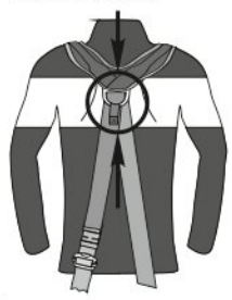
Рис. 10. Правильное положение страховочной точки А на спине
