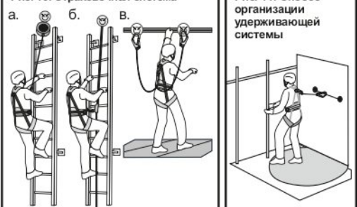
Рис. 13. Пример организации системы канатного доступа
