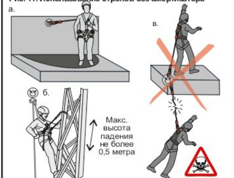
Рис. 11. Использование стропов без амортизатора
