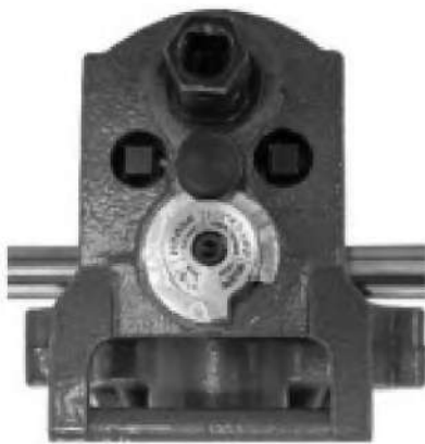
Рис 7А. Параметр правильной глубины канавки расположен непосредственно под регулировочной гайкой
