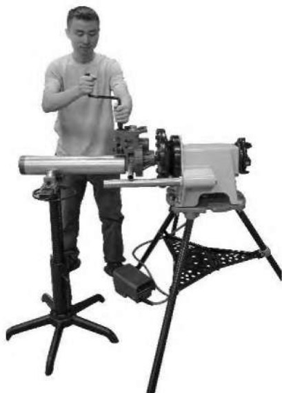
Рисунок 9 - Рабочее положение во время прокатки канавок
