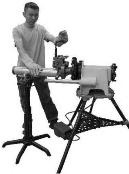
Рисунок 10 - Приложение усилия к трубе для предотвращения отклонения при накатке канавок
