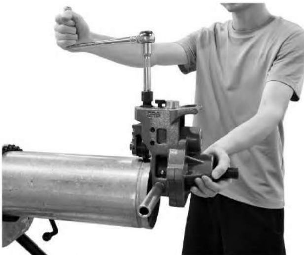
Рисунок 11 - Крепко удерживайте станок во время затягивания подающего винта.
