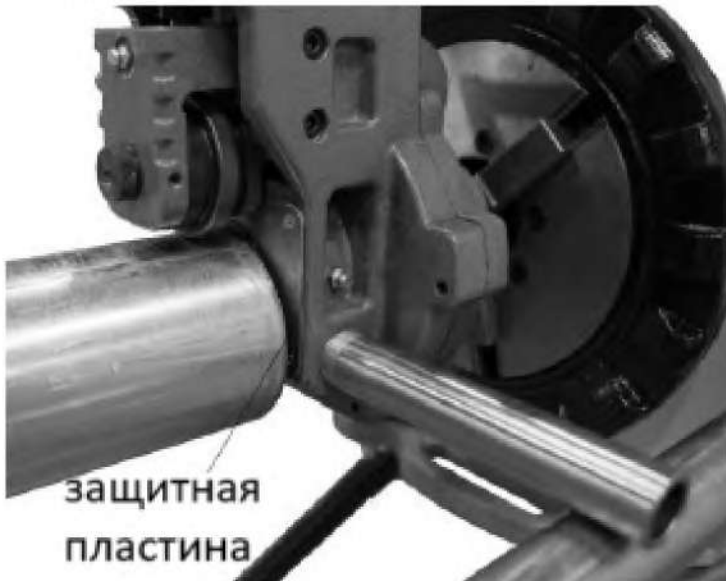
Рисунок 5- Предотвращение контакта трубы с приводным валом и защитным кожухом
