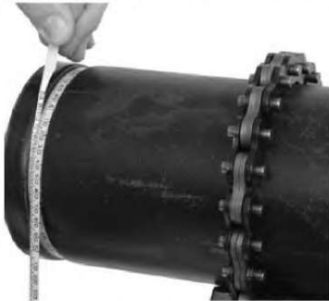
Рисунок 8 — Измерение диаметра желобка с помощью кронциркуля
