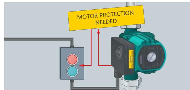
При подсоединении насоса к системе электроснабжения используйте провод сечением не менее  $3 \times 1.5\text{мм}^2$ , внешний диаметр провода должен соответствовать диаметру муфты уплотнения кабеля распаячной коробки насоса для обеспечения герметичности подсоединения.
