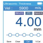
Далее нанесите тонкий слой контактного геля на площадку для калибровки. Прижмите датчик к поверхности площадки. Дождитесь завершения процесса калибровки. После этого прибор автоматически вернется в режим измерения.
