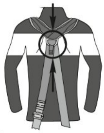
Рис. 10. Правильное положение страховочной точки А на спине
