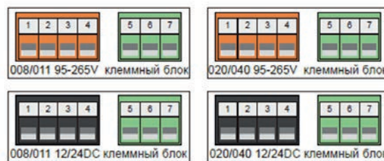
Рис.8. Схема подключения клеммной колодки.
