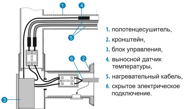
\* **ВНИМАНИЕ** Электрическое подключение должно производиться на отключенном от сети оборудовании. Монтаж прибора должен осуществляться только квалифицированным электриком. Не допускается самостоятельная разборка прибора и вмешательства в конструкцию.
