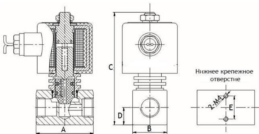
Рисунок 1 – Размеры клапанов DN8-10
