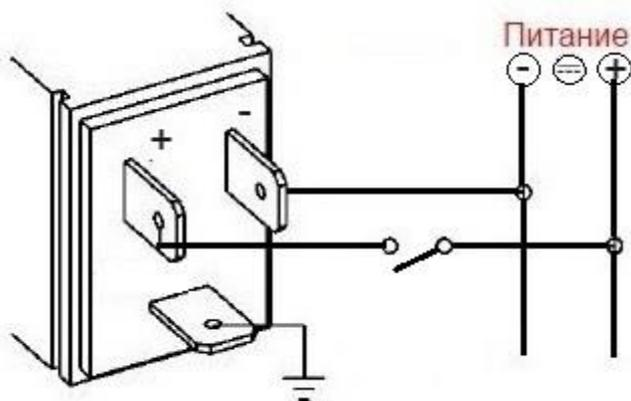
Рисунок 4 – Схема подключения на постоянное напряжение
