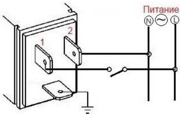
Рисунок 3 – Схема подключения на переменное напряжение
