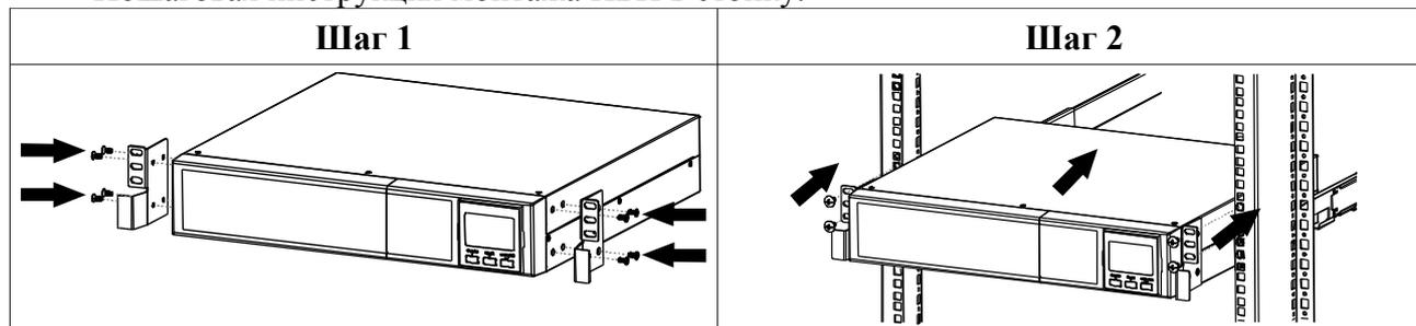
Смонтировать на корпусе ИБП крепежные элементы из комплекта поставки ИБП. Установить и зафиксировать ИБП в стойке.
