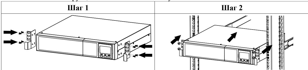
Смонтировать на корпусе ИБП крепежные элементы из комплекта поставки ИБП.
