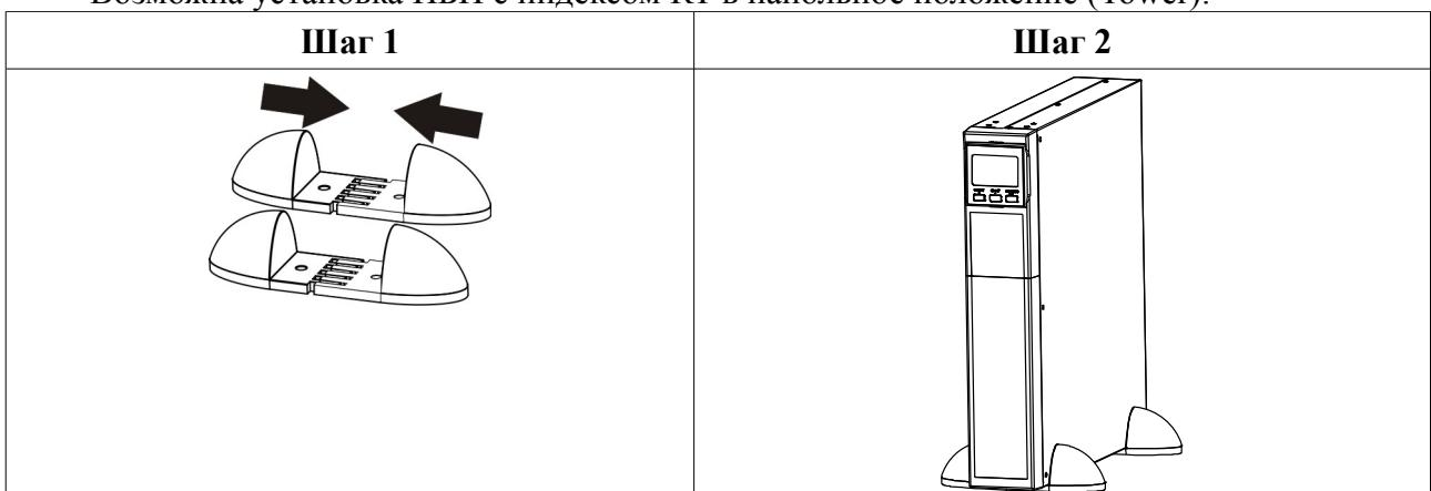
Смонтировать «ножки» из комплекта поставки. Установить ИБП в положение Tower.
