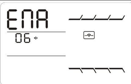
Разрешает или запрещает байпас при выключенном ИБП
