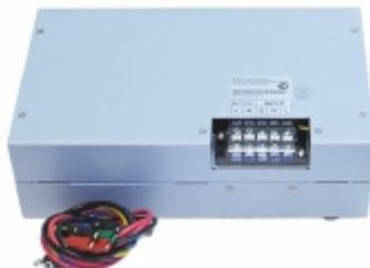
Каждое зарядное устройство CHG\240-4A позволяет подключить к ИБП дополнительно батареи емкостью до 100Ач. При увеличении количества зарядных устройств без увеличения емкости батарей время заряда батарей уменьшается. Всего может быть подключено до 4 зарядных устройств в параллель. Таким образом, общая емкость подключенных к ИБП батарей может достигать 400Ач.
