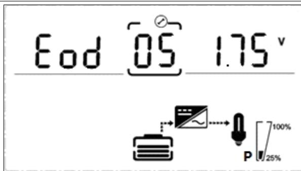
Позволяет настроить границу напряжения разряда АКБ при котором появится соответствующее предупреждение:
