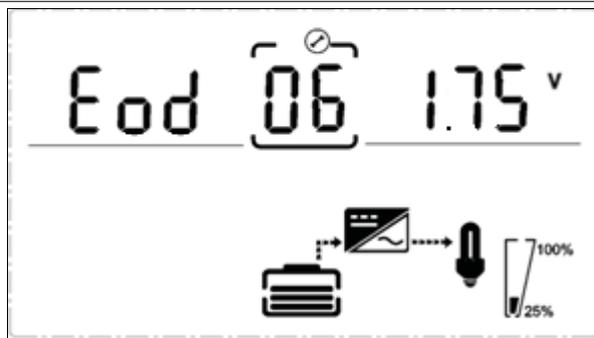
Позволяет настроить границу напряжения разряда АКБ при котором ИБП выключится:
